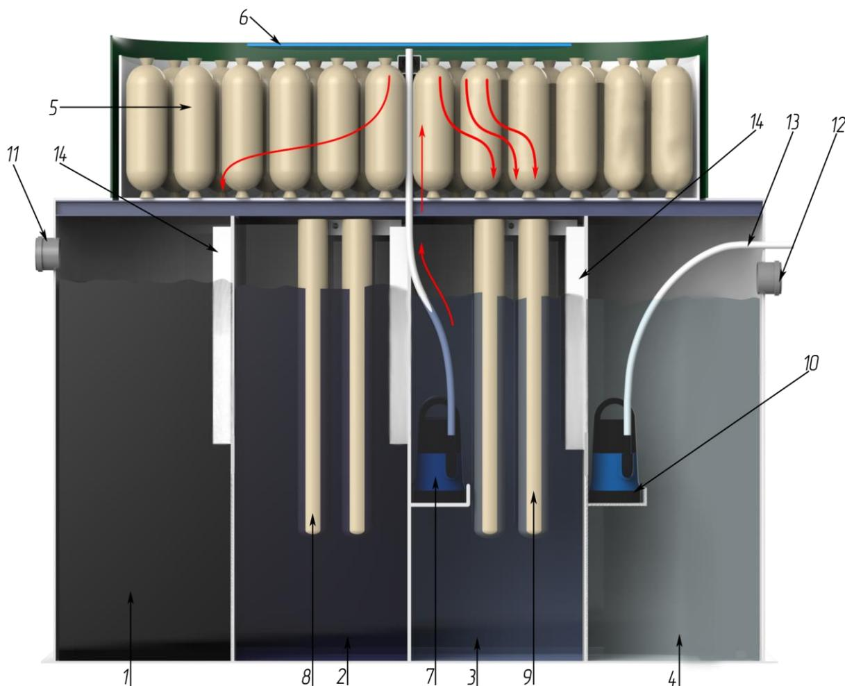
Сточные воды попадают в очистное сооружение через вводной патрубок диаметром 110мм (11).
